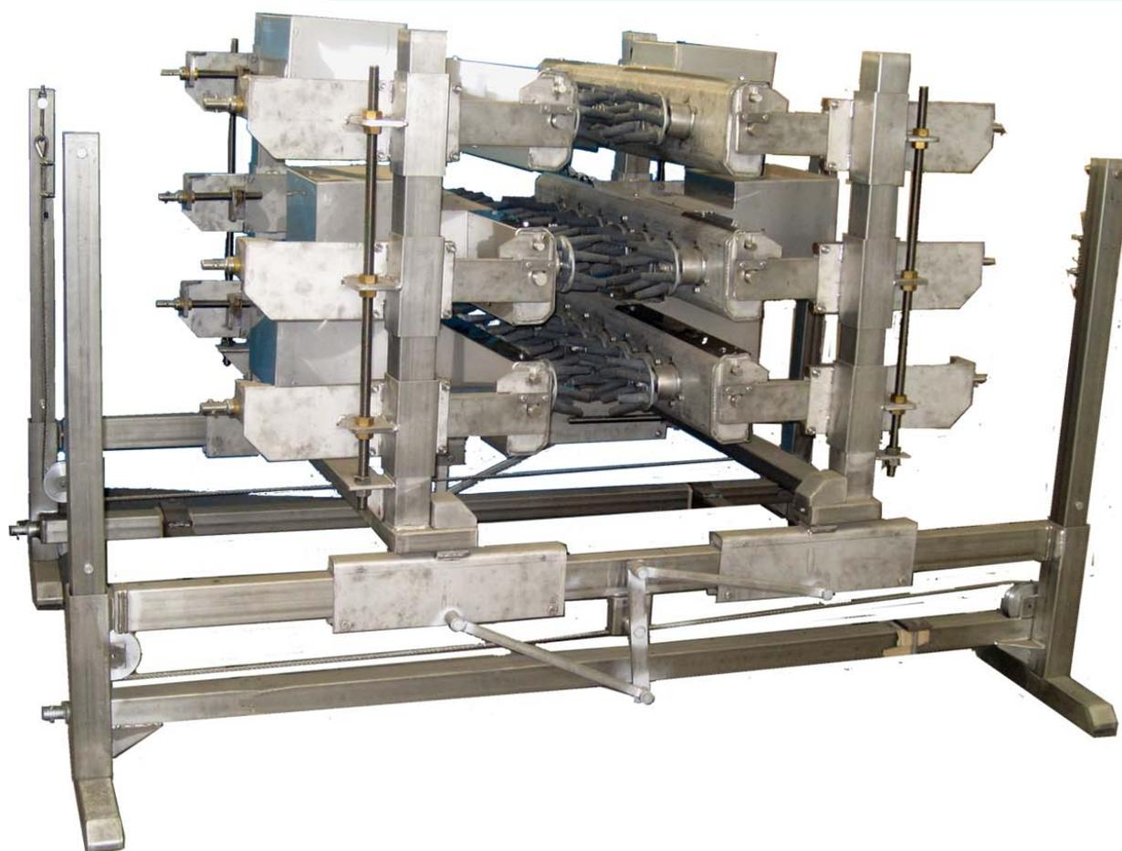
Systeme de 3 rangées de toupies orientables, pour une finition optimale de la volaille.
